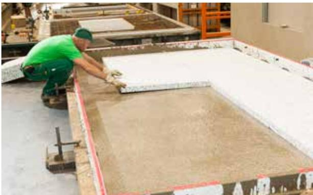
Frisch betonierte Vorsatzschale mit Wärmedämmplatten belegen.
