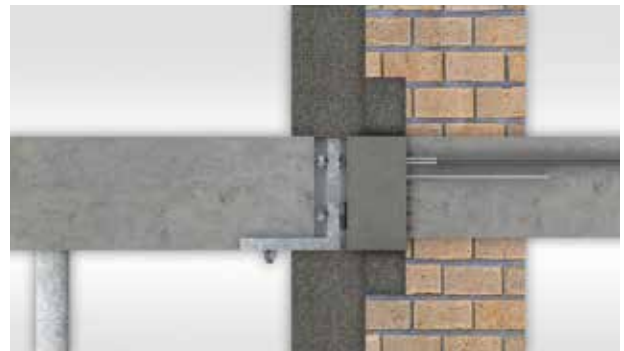
Gestützter Stahlbetonbalkon, nachträglich angeschlossen mit Schöck Isokorb® RT Typ SKP an bestehende Stahlbetondecke im Mauerwerk.
