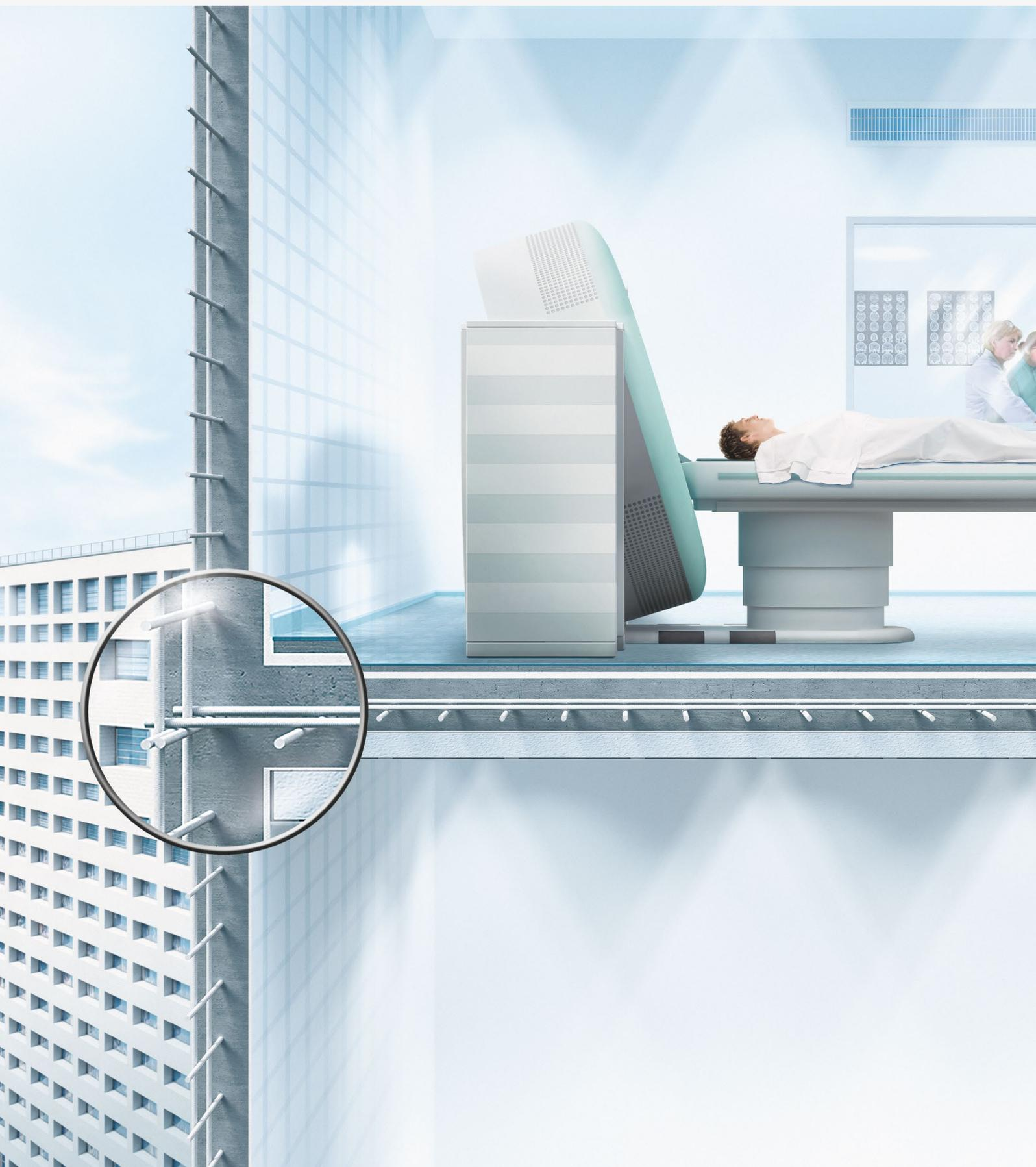
Forschungslabore für Rasterelektronenmikroskopie, Magnetspintomographie und Magnetresonanztomographie sind hochsensible Einrichtungen. Wegen seiner magnetischen Eigenschaften kann Bewehrungsstahl die Funktionalität und Genauigkeit der genutzten Forschungsgeräte beeinträchtigen.
