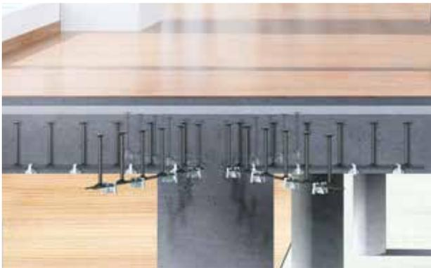
Die Schöck Bole® erhöht die Tragfähigkeit von Flachdecken im Bereich von Stützen. Dies ermöglicht dünnere Decken und schlankere Stützen.
