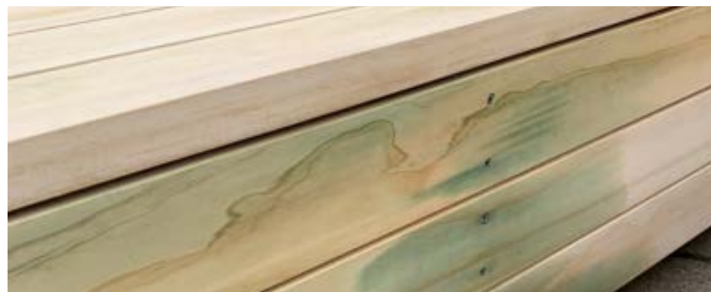
DOCHTWIRKUNG VON CHEMIKALIEN BEI DRUCKBEHANDELTEM WEICHHOLZSPANTENWERK DURCH ACCOYA
