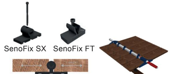
Für die Verlegung mit Senofix SX ist die Montagezwinde zwingend nötig. Dadurch kann ein gleichmäßiger Fugenabstand von 6 mm erreicht werden. Die Verlegung mit Senofix FT ist auch ohne Zwinde möglich.
