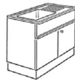
**Laborspülen**, Unterschränke mit Beckenblende, zweitürig; Bänder kunststoffbeschichtet, Einlegeboden; Spülbecken links (oder rechts) inkl. Sieb, Standrohr und Siphon, Abtropfplatte einseitig, Wulstrand umlaufend; Abfallsammler hinter Drehtür
